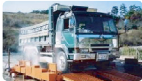
タイヤ泥落とし装置の設置
