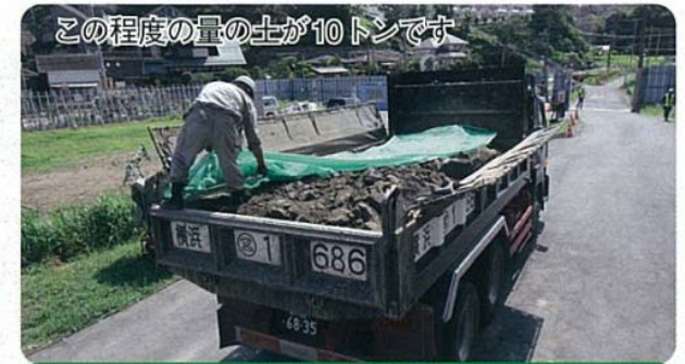
走行中に土が飛ばないようにシートで覆っています。
