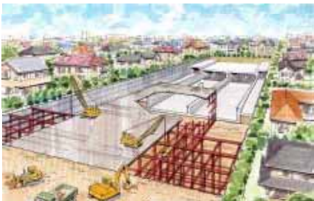
開削工法イメージ図
