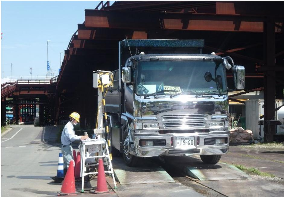
車両重量計による計測状況
