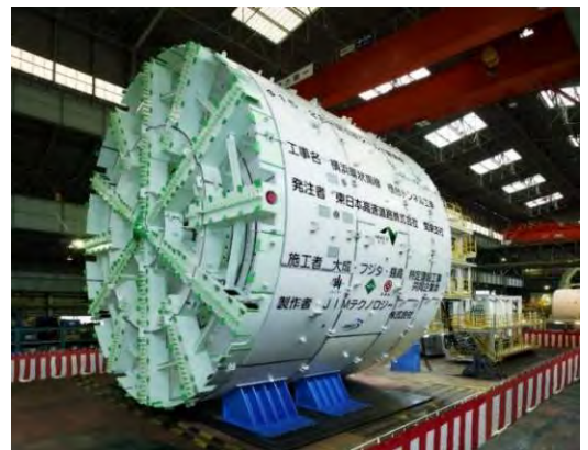
桂台トンネル シールドマシン (工場仮組時)
