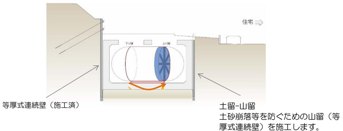
施工イメージ図（回転立坑断面図）
