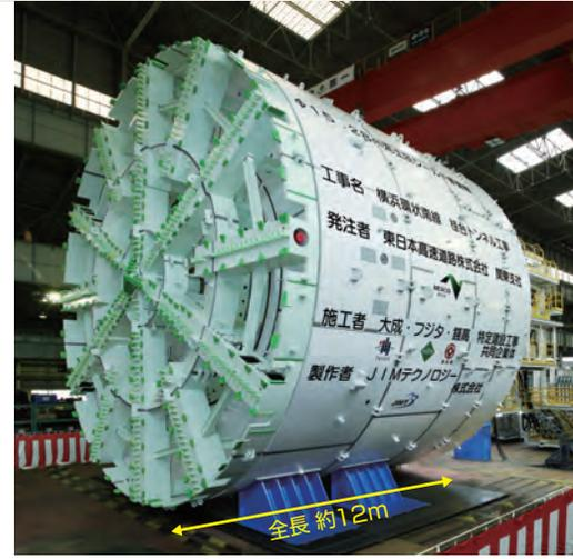
▲工場で完成したシールドマシン(トンネル掘削機)
