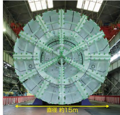
▲シールドマシン先頭の回転して掘削する部分(カッターフェイス)
