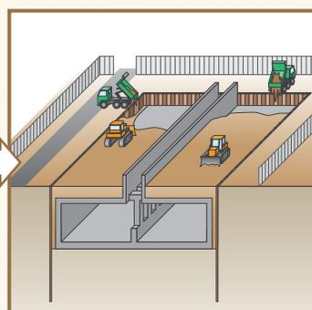
道路の本体部分が完成した後、土で埋め戻します
