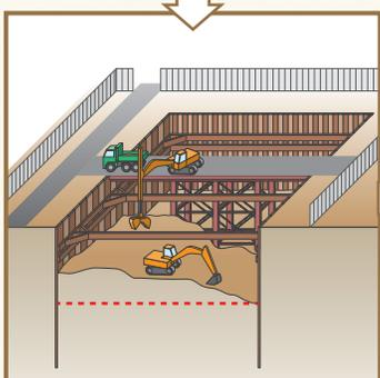
囲った壁の中を掘削します。掘削した土はダンプトラックで搬出します
