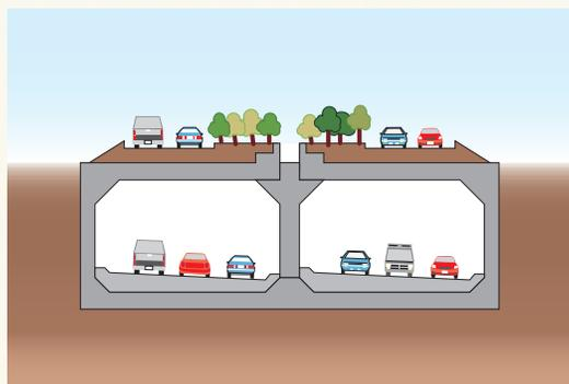
▲掘割構造標準断面図
