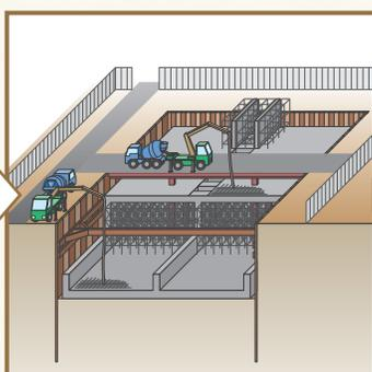
道路の本体部分をコンクリートで施工します。コンクリートはミキサー車で搬入します
