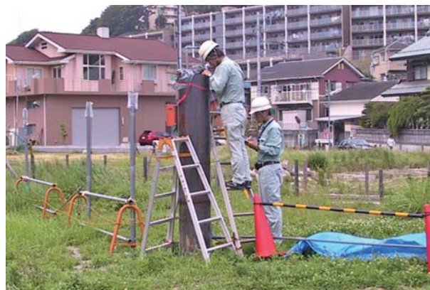
▲中央の太い管が試験用の井戸。ここから地下に注水し、奥に並んだ3本の細い管で、地下水位の変化を調査します
