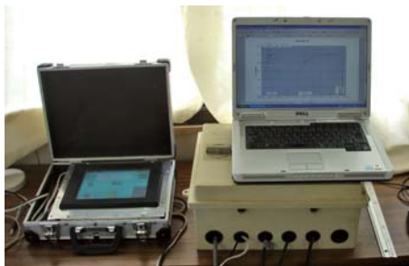
◀注水量を管理し、地下水位の変化をパソコンに記録しています
