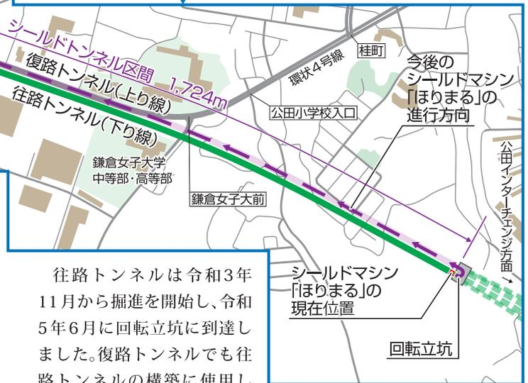
往路トンネルは令和3年11月から掘進を開始し、令和5年6月に回転立坑に到達しました。復路トンネルでも往路トンネルの構築に使用したシールドマシンで掘進を行うため、マシンをUターンさせる必要があります。このマシンをUターンさせるための場所が「回転立坑」です。「回転立坑」は深さが約22メートルあり、5階建て相当の建物と同程度の大きさがあります。
