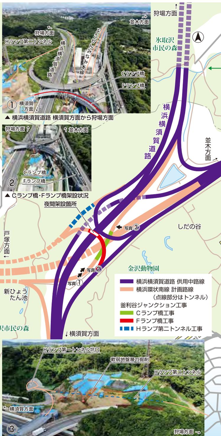
▲ Hランプ第二トンネルの掘削前に、軟弱地盤層を掘削・置換する工事を実施
