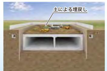
構築した構造物を埋戻して完成します。その後、構造物内の舗装や設備などの整備と、地上部の道路などの整備を行います
