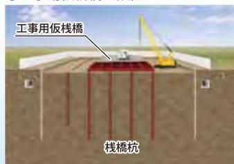
掘削する重機を設置したり、掘削した土などを運び出すための栈橋を設置します
