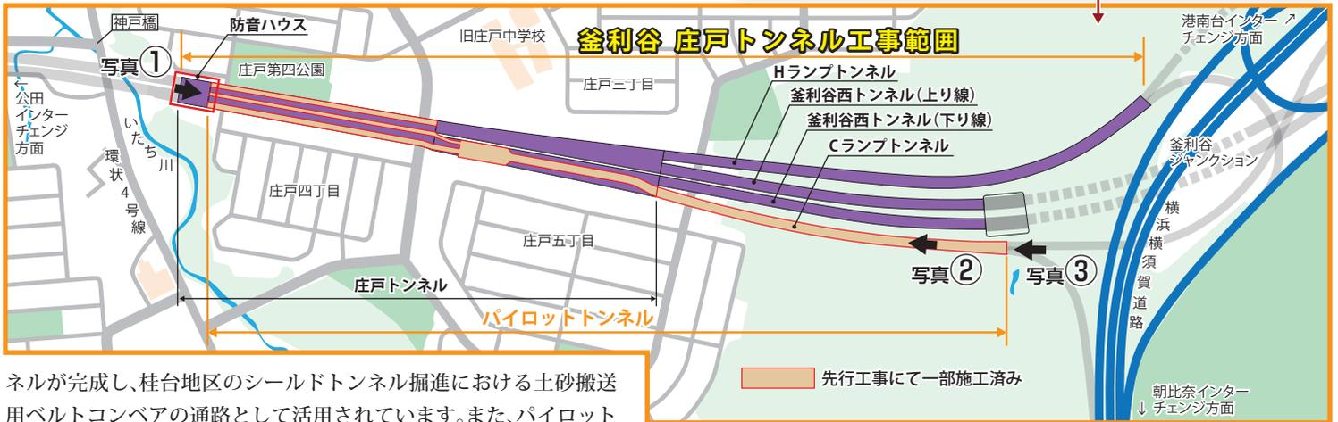
ネルが完成し、桂台地区のシールドトンネル掘進における土砂搬送用ベルトコンベアの通路として活用されています。また、パイロットトンネルの一部区間に併設した2本の小断面トンネル(底部導坑)も完成し、本線トンネル工事の着手に向けた準備が進んでいます。
