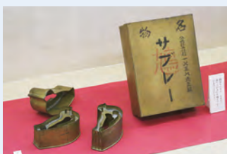
▲昔の鳩サブレの抜き型。その形と大きさは、製造が機械化された今も変わりません。唯一、尻尾の線が2本から3本に変わっています
