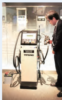
緊急用バッテリー可搬式計量機 いざという時に給油を可能にする
