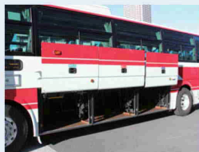
▲空港リムジンバスは行く先のターミナルごとに分かれたトランクスペースが特徴！
