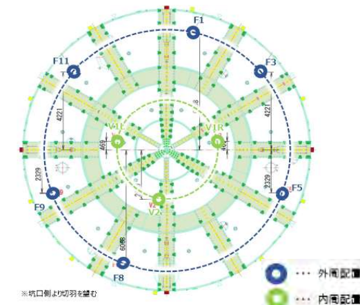
チャンバー内土圧計配置図
