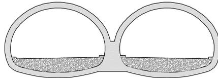
掘削と同時に吹付けコンクリートなどにより地山の安定を確保しながら施工する工法で、地山自身のアーチ効果を利用することでトンネル本体にかかる負荷が軽減される。坑内を掘削機械などによって掘り進み、後方へ掘削土を搬出しながら施工する。
