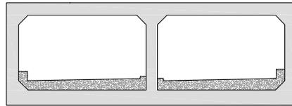
地表面から所定の深さまで地面を掘り下げ、地下に一時的に空間を確保して、その空間に構造物を築造した後、上部空間を埋め戻して施工する工法。
