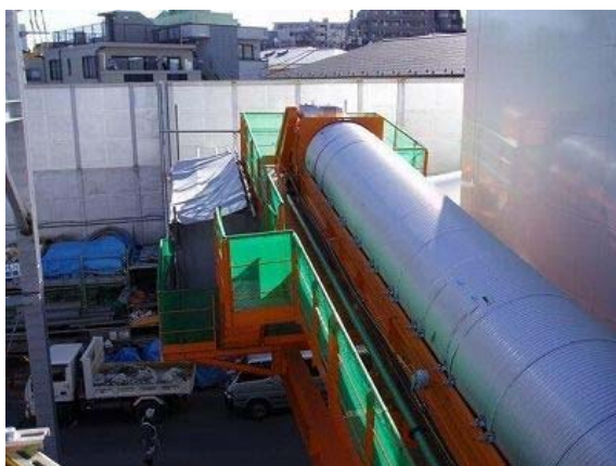
防音カバー付きベルトコンベヤ
